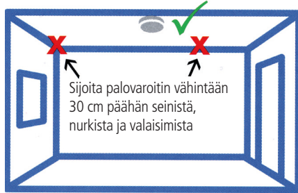
Varoittimen asennus huoneeseen
