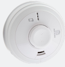
Lämpöilmaisin EI3014 • Hälytysraja: 58° +/- 4° C • 10 vuoden akku • EN5446-2:2003 • Sähkönumero: 71 397 03
